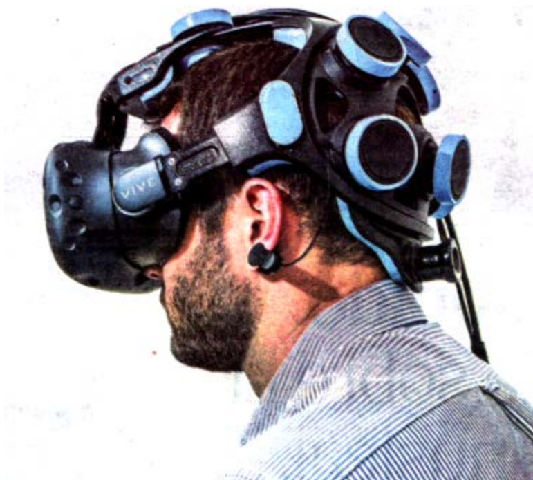
El casco lleva anteojos de realidad virtual y siete sensores electroencefalográficos
