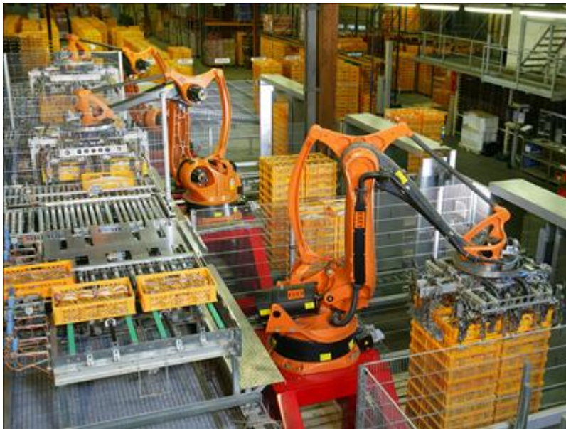
Automatización de fábrica con robots industriales KUKA para paletizar productos alimenticios como pan y tostadas en una panadería en Alemania
